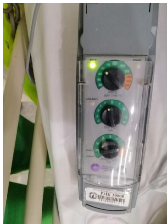
รูปที่ 14 รูปแสดงการทำงานของสัญญาณไฟ pacing (สีเขียว) ปกติ ซึ่งจะกระพริบตาม rate ที่ตั้งไว้
